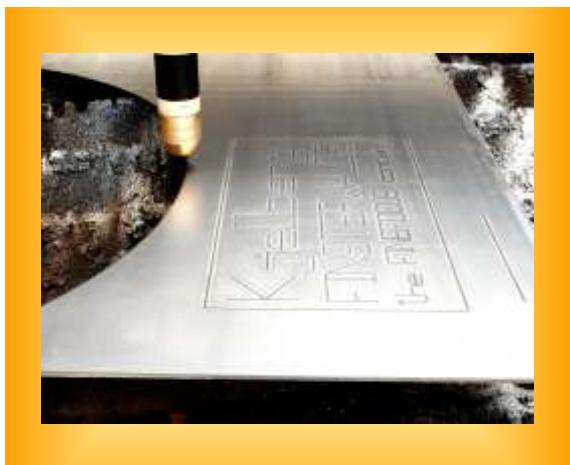
С помощью **бесступенчатой установки** тока маркировки в интервале от 4 до 25 А возможна окончательная или временная маркировка листа и профилей. При большой глубине насечки маркировка видна даже после нанесения на поверхность покрытия. Соответствующее программирование ведущей машины делает возможным нанесения точечных насечек.
